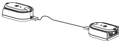
Klonen des Funkgeräts über ein Einzelschacht-Ladegerät
