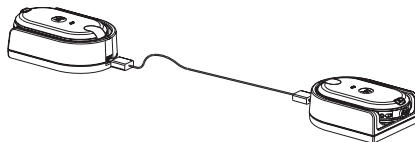
Clonación de la radio mediante un cargador de una sola unidad
